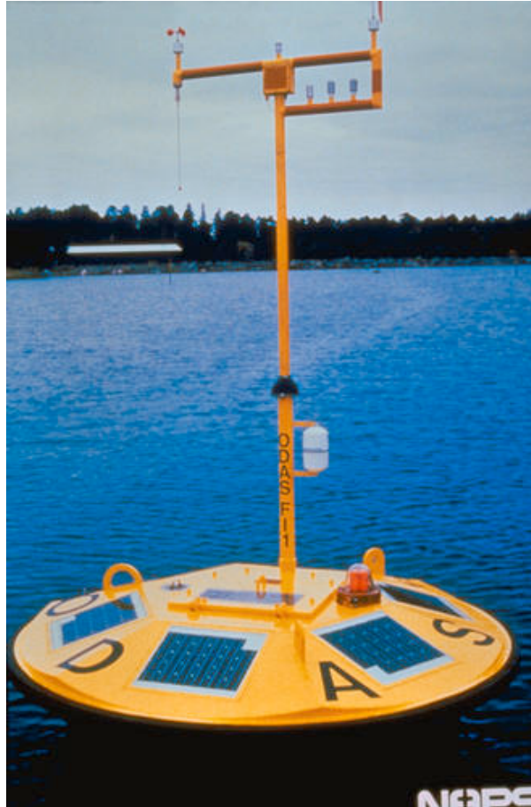
FIGURE 9 Bouée Solaire Servant à la Collecte d'Informations Météo au large de la Côte Est des Etats Unis (Source: NREL 2006b)
