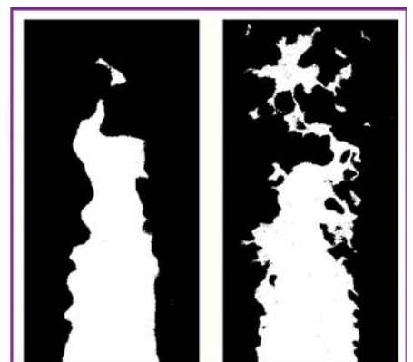
De gauche à droite : vue de la chambre de combustion haute pression d'ICARE pour l'étude des flammes turbulentes ; visualisation par tomographie plan laser d'une flamme conique turbulente de prémélange méthane-air ; images instantanées de la même flamme pour deux pressions différentes, 1 bar et 9 bars ; © ICARE-CNRS.
