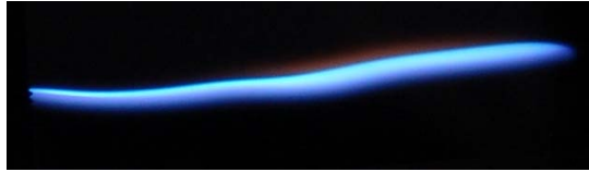
Flamme de diffusion à contre courant en présence d'espèces excitées de l'oxygène
